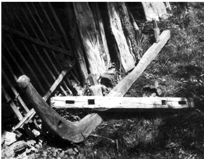
Рис. 6. Полоз (“копаниця”) господарських саней центральноєвропейського типу з отвором у його головці для кріплення волового дишла (“війця”) (с. Зарічеве Перечинського р-ну Закарпатської обл. 1984 р. Фото автора).
