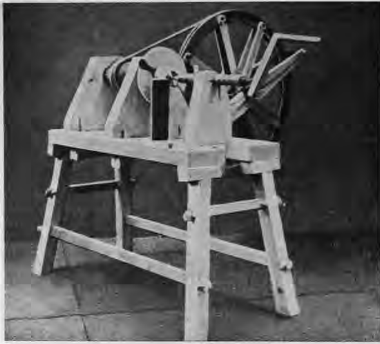
Рис. 4. Римский токарный станок для обработки металла (реконструкция А. Мутца)
