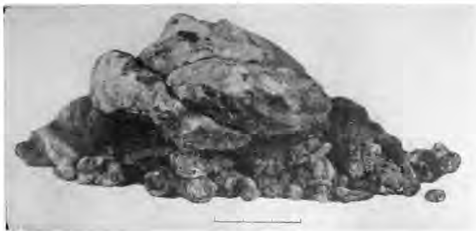
Рис. 6. Шлаковый слиток из печи № 2 с. Пилпчатино
