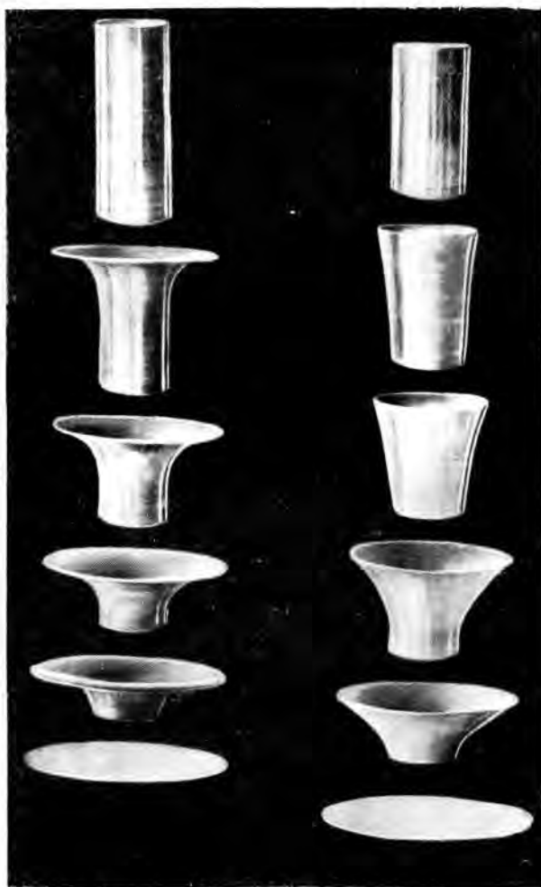
Рис. 15. Промежуточные формы развития оболочек при выдавливании алюминиевой пластинки в цилиндрический стакан
