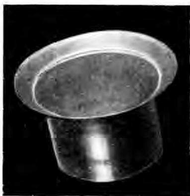
Рис. 17. Выдавленное изделие с характерными круговыми следами давилника
