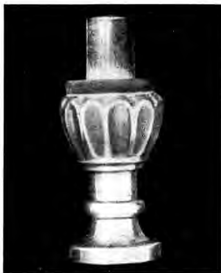
Рис. 32. Деталь ножки погребального ложка, выдавленная нами из алюминиевого листа на деревянном сердечнике
