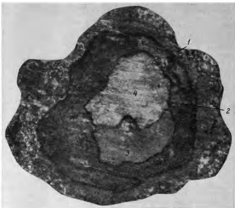
Рис. 2. Макроструктура поперечного среза шила (ув. 23)
