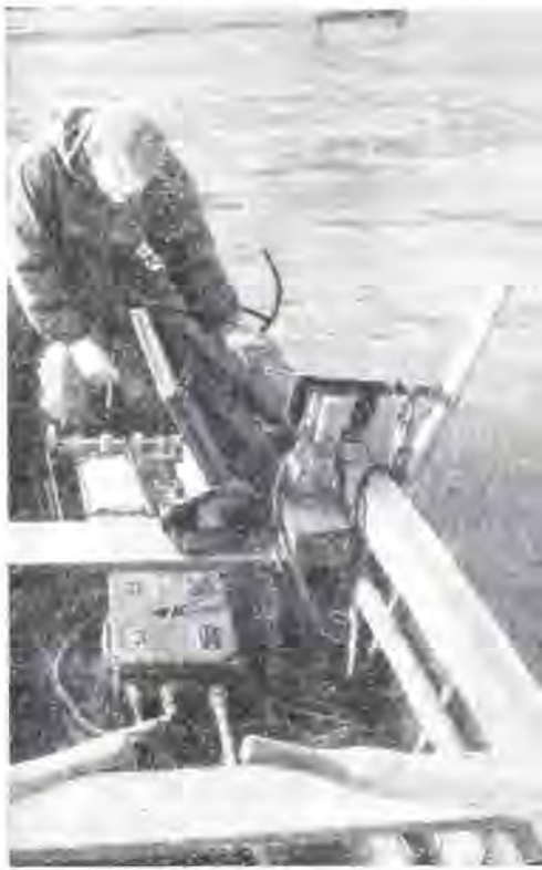
Рис. 1. Звуковой геолокатор ЗГЛ-1, установленный в лодке. Виден регистратор с лентой и подвесная система излучателя, который находится за бортом
