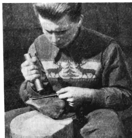
Рис. 9. Чистовая ковка медного кинжала медным молотком на камне
