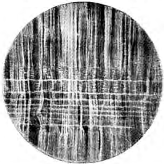
Рис. 4. Строение древесины новгородского гребня. Самшит, радиальный срез. \times 150
