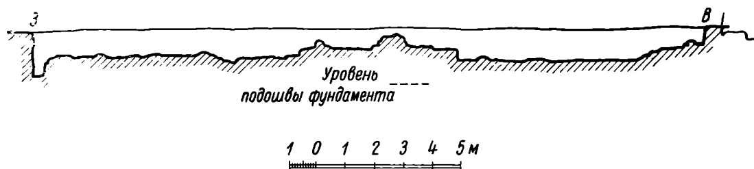
Рис. 8. Продольный разрез фундамента северной стены храма.
